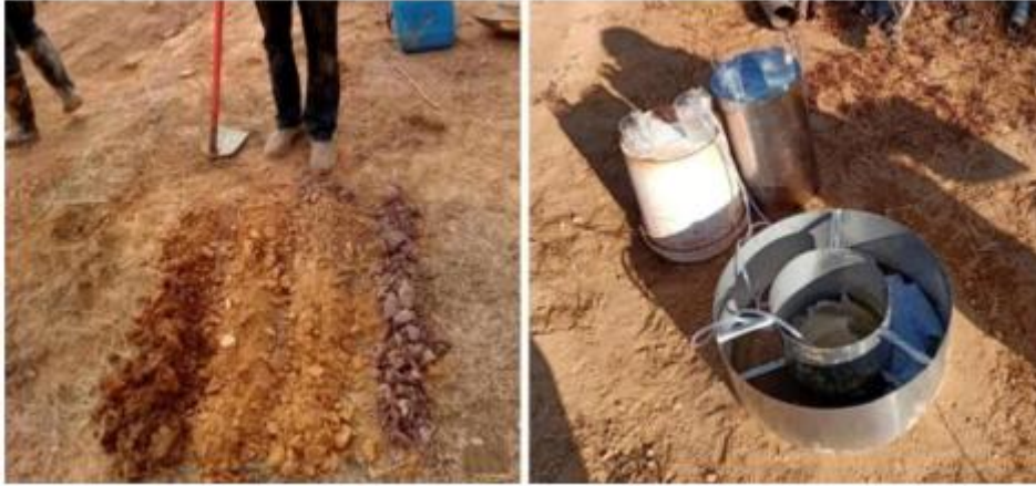
5.10-6 渗水试验现场图
